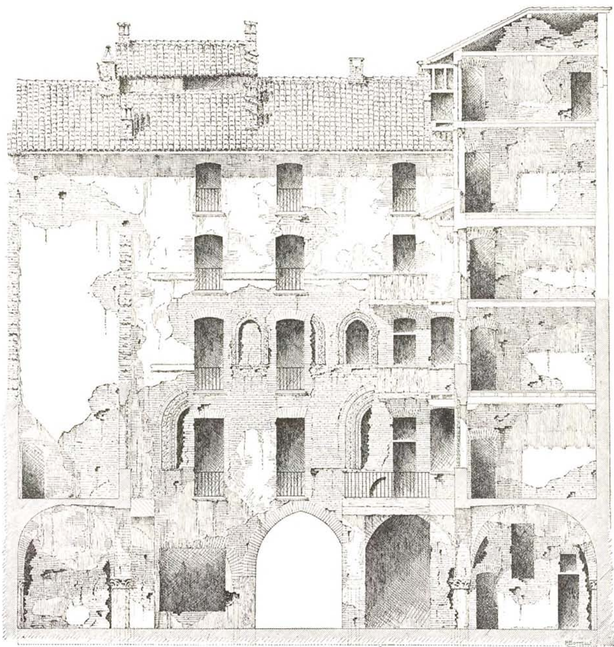
CASA MISSAGLIA. — Sezione trasversale del Cortile, rilevata nel corso delle demolizioni.
